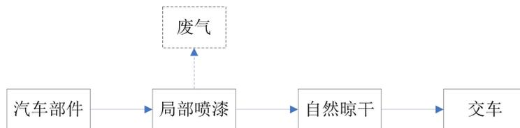
图3 喷漆工序工艺流程及产污环节
